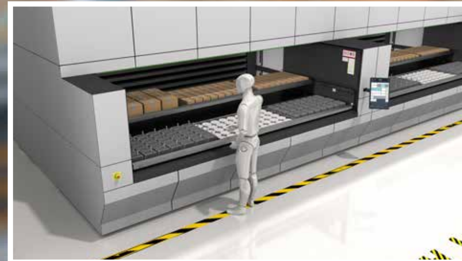
Doppio livello del cassetto per l'ottimizzazione dei flussi
