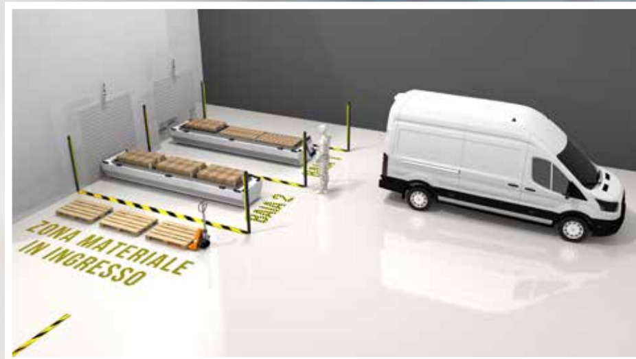
Baie Laterali Esterne per un refilling continuo dell'impianto
